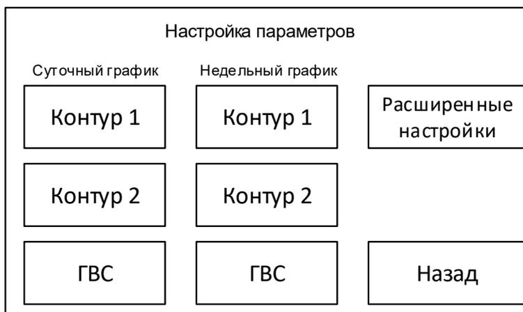
Откроется окно настройки параметров. Для настройки суточного графика контура отопления или ГВС, нажмите кнопку суточного графика соответствующего контура.
