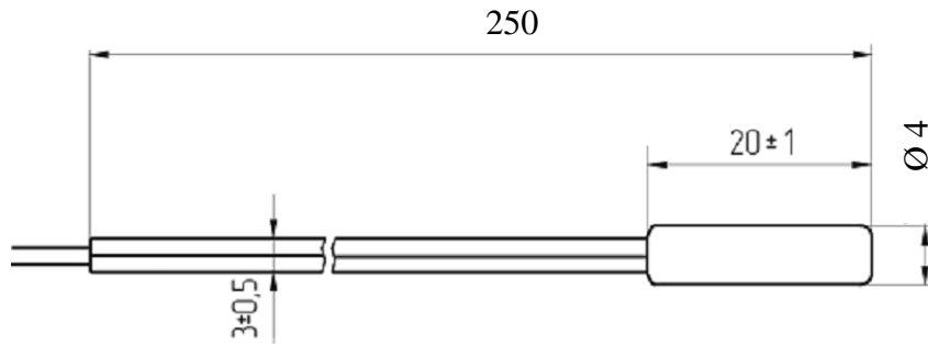
Рисунок 17 Габаритные и установочные размеры датчиков температуры теплоносителя (T1-T4).
