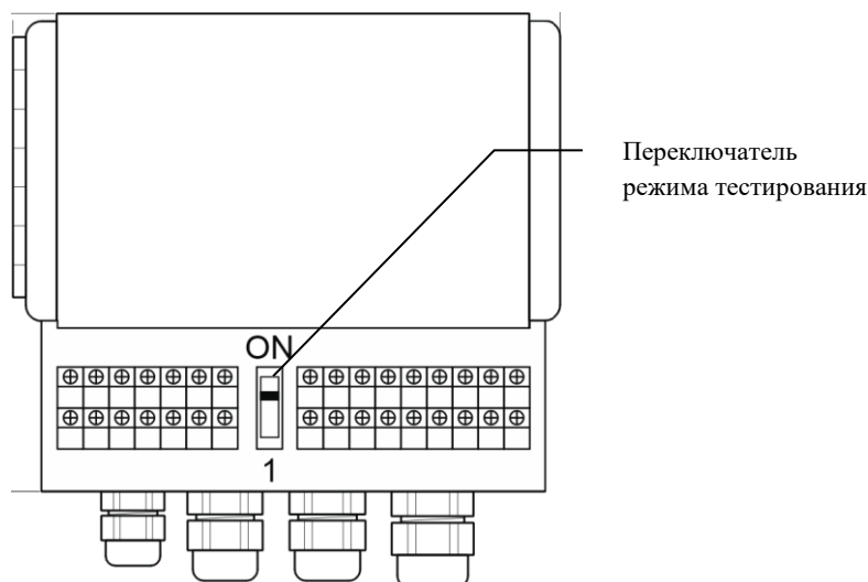
Рисунок 6 Расположение переключателя Тестирование/Рабочий режим
